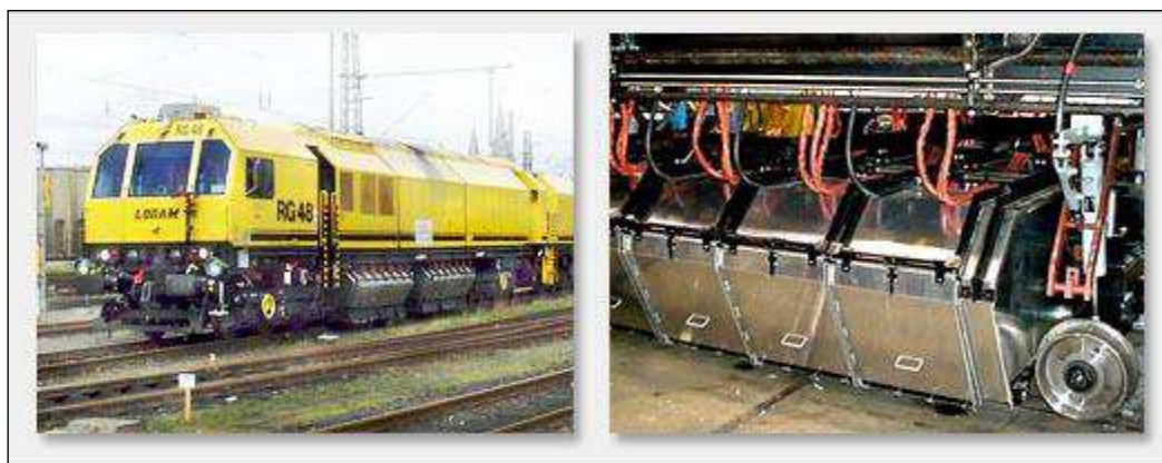
Rysunek 8. Widok maszyny do szlifowania szyn RG 48 I +II [Źródło: www.schweerbau.de/]
